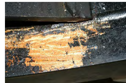
Rys. 7. Substancja smolista na obudowie wewnętrznej pieca powstała ze zmieszania się sadzy oraz olejów z niewłaściwie umytych wsadów.
