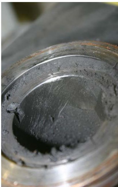
Rys. 3. Sadza na wlocie do pompy mechanicznej
