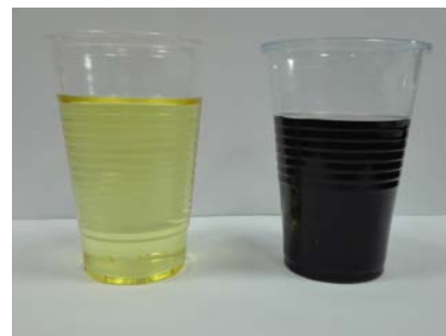
Rys. 6. Olej z pompy mechanicznej po wymianie i przed wymianą
