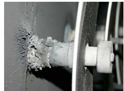
Rys. 11. Osadzenie się sadzy na ceramicznych elementach pieca
