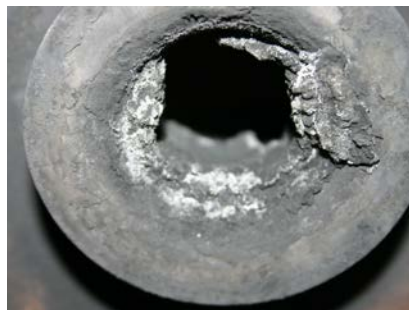
Rys. 10. Osadzenie się sadzy i innych materiałów z niewłaściwie przygotowanych wsadów na elementach pieca
